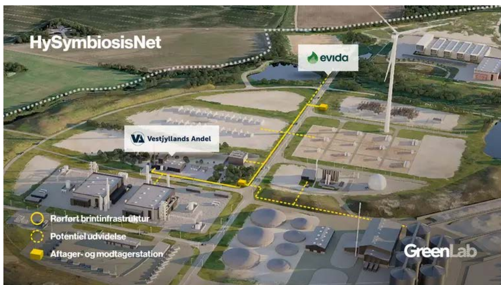
Figur 8. Symbiose mellem nabovirksomheder og kaskadeprocesser ved GreenLab Skive. Foto: GreenLab Skive.
